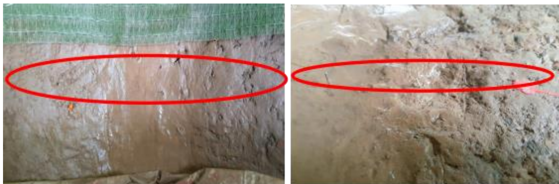
图 2 特拉锚垫系统防护段及无防护段断面冲刷对比情况 ( U=1.5\text{m/s} )
